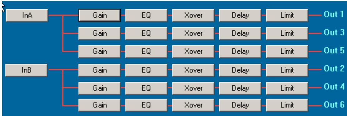
Para acceder a la ventana de ajuste, pulsaremos sobre la entrada o salida que queramos modificar y se abrirá la ventana con pestañas que nos permitirá acceder a los ajustes de las entradas o las salidas para modificar los parámetros que se deseen.
