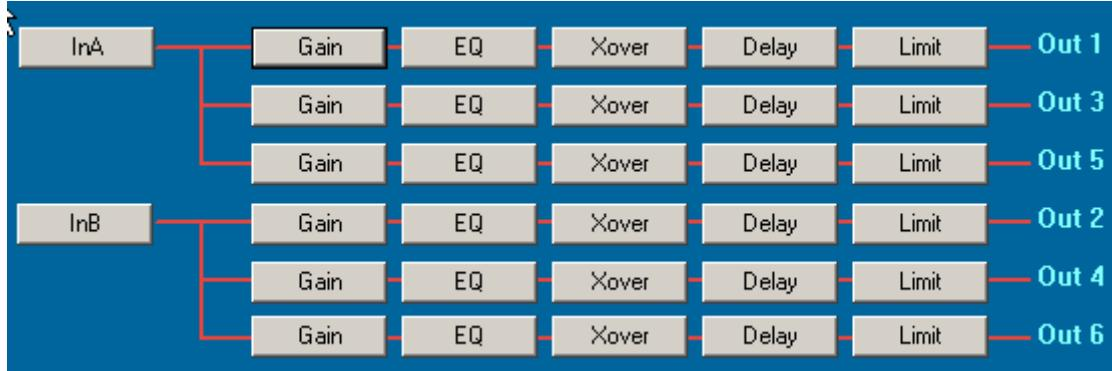
Um zum Einstellfenster zu gelangen, muss der zu ändernde Eingang oder Ausgang angeklickt werden, dadurch öffnet sich dann das Fenster mit den entsprechenden Reitern, die den Zugang zu den Ein- oder Ausgängen ermöglichen, um dort die gewünschten Parameteränderungen vorzunehmen.
