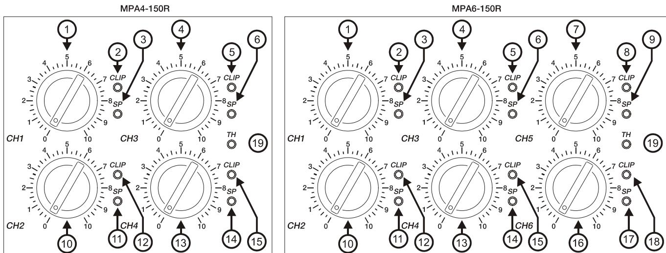
Estos atenuadores posibilitan la conexión a distintos tipos de mesas, regulación de nivel independiente y conexión de altavoces que soporten una potencia inferior a la suministrada por el amplificador a pleno rendimiento, sin peligro de dañarlos por un descuido al manejar el volumen del preamplificador-mezclador.
