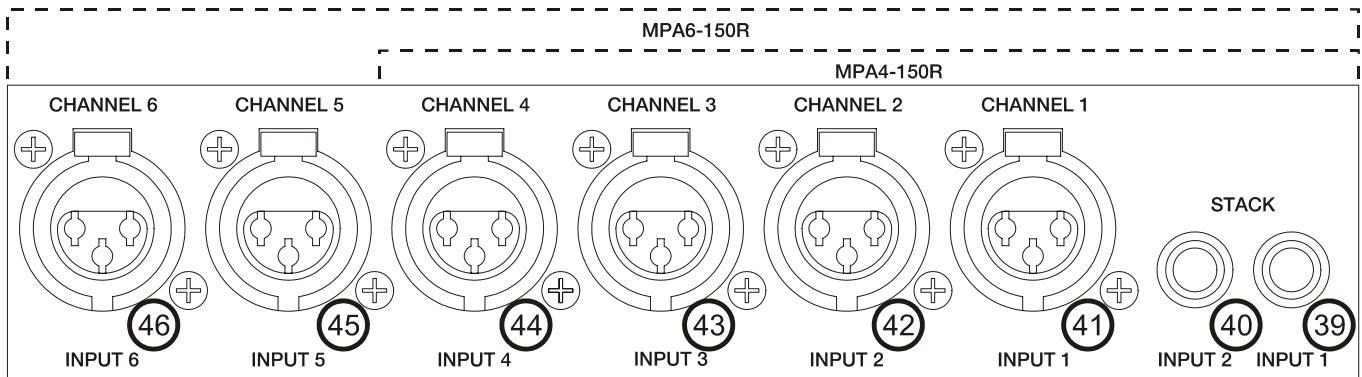
Die Eingangsbuchsen des MPA R (41, 42, 43, 44, 45, 46) sind elektronisch symmetrierte XLR-Buchsen mit einer Eingangsimpedanz von  $>20\text{k}\Omega$  und einer Nennempfindlichkeit von 0dBV(1V). Die Pinbesetzung ist:
