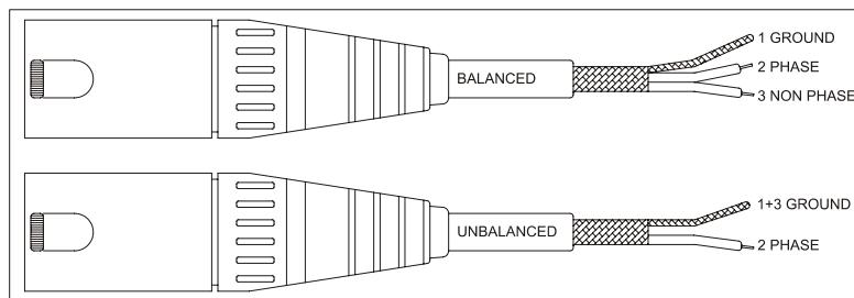
Die "STACK" Anschluss (39, 40) sind mit den Eingängen "INPUT 1 INPUT 2" parallel geschaltet und werden verwendet, um das gleiche Eingangssignal zu anderen Verstärkern oder Geräten zu senden. Diese Signalausgänge sind mit  $\frac{1}{4}$ " Klinkenbuchsen ausgestattet. Die Pinbelegung der Anschlüsse ist wie folgt:
