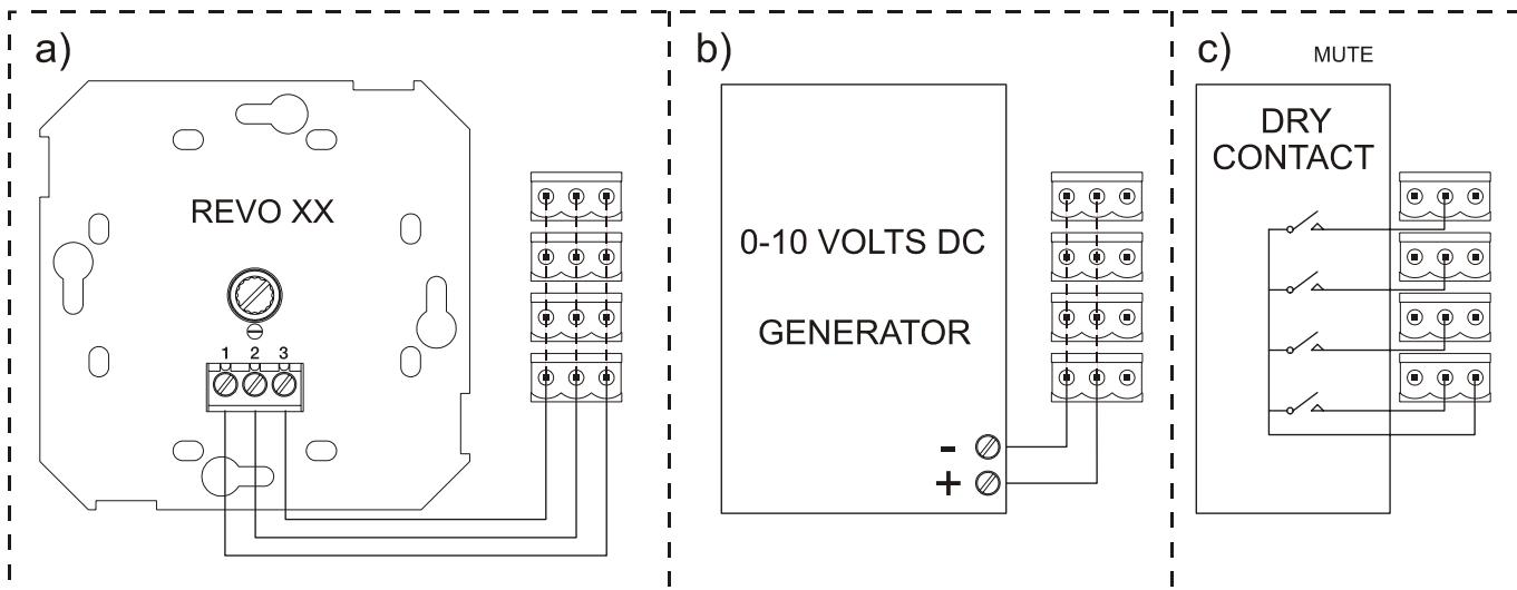
**HINWEIS:** man kann maximal 16 parallele Eingänge an einen einzigen Kontrollregler anschliessen. Es ist erforderlich, dass die Erdkontakte aller Verstärker miteinander verbunden sind.
