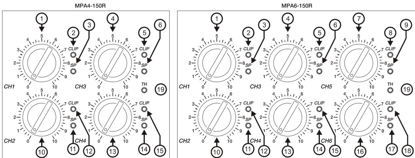
Ces atténuateurs permettent de connecter différentes consoles de mixage, de régler le volume de façon indépendante et de brancher des HP pouvant supporter une puissance inférieure à celle administrée par l'amplificateur à plein rendement, sans aucun danger de les endommager par une manipulation exagérée du volume de la console de mixage.
