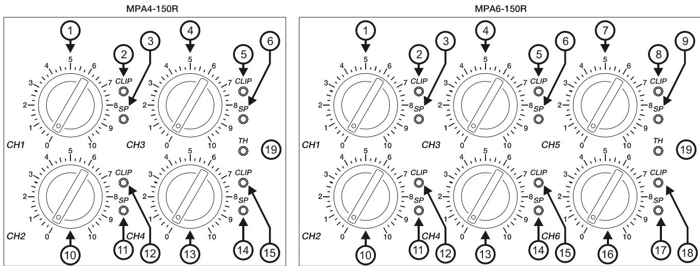
Diese Trimmer ermöglichen den Anschluss verschiedener Mischpulte oder Vorverstärker, unabhängige Volume-Regelung pro Kanal und den Anschluss von Lautsprechern, die die Höchstleistung des Verstärkers nicht bestehen würden. Damit wird die Gefahr, die Lautsprecher durch eine Fehlmanipulation am Mischpult oder Vorverstärker zu beschädigen beseitigt.
