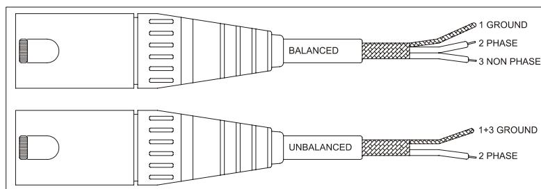
Los conectores "STACK" (39, 40) están en paralelo con las entradas y sirven para conectar la misma señal que tenemos en las entradas "INPUT 1, INPUT 2" a otros amplificadores o sistemas de sonido. Estos conectores son del tipo jack 1/4" siendo la asignación de patas la siguiente:
