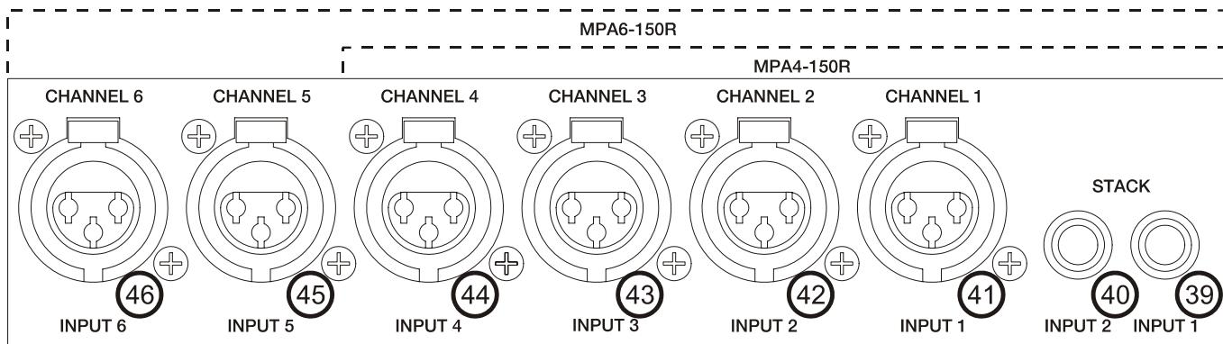
Las entradas de señal (41, 42, 43, 44, 45, 46) son del tipo XLR-3 balanceadas electrónicamente, con una impedancia de entrada superior a  $20\text{k}\Omega$  y una sensibilidad nominal de  $0\text{dBV}(1\text{V})$ . La asignación es la siguiente:
