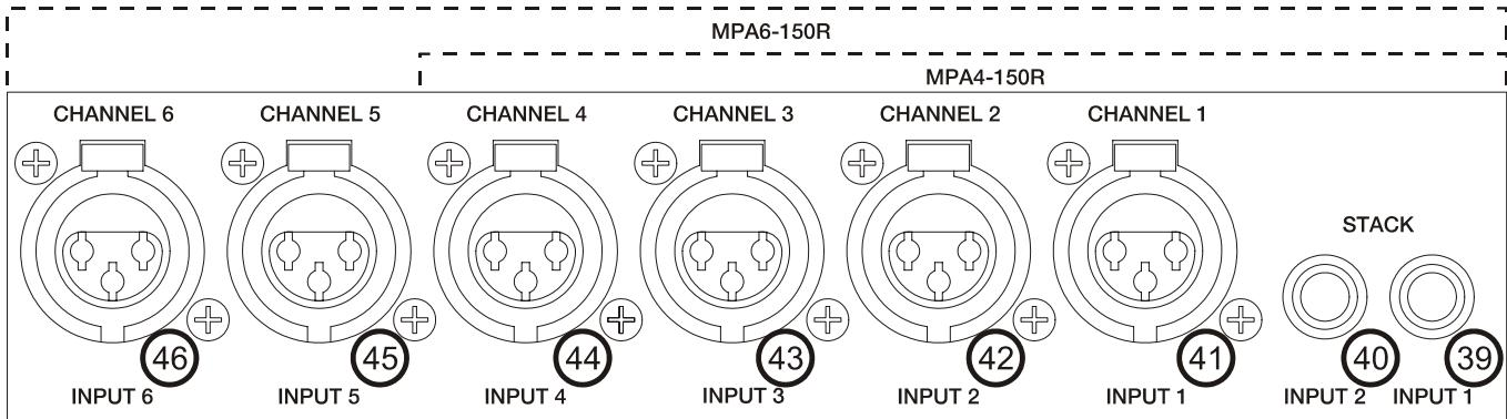
Les entrées du signal (41, 42, 43, 44, 45, 46) sont de type symétriques XLR-3 avec une impédance d'entrée supérieure à  $20\text{k}\Omega$  et une sensibilité nominale de  $0\text{dBV}(1\text{V})$ . L'assignation est la suivante:
