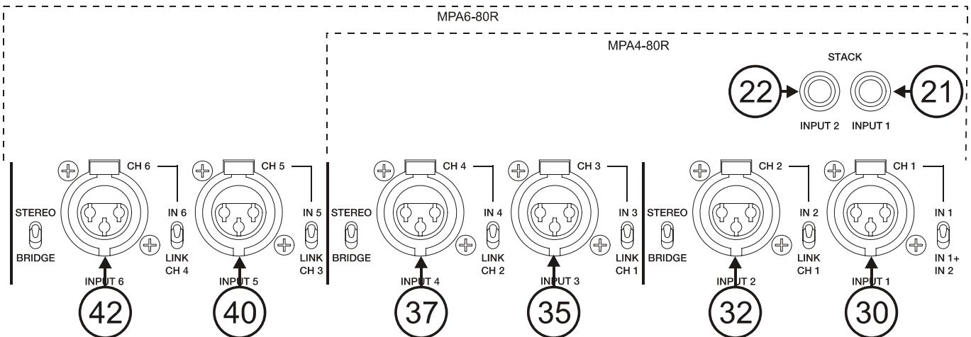
Les entrées du signal (30, 32, 35, 37, 40, 42) sont de type symétriques XLR-3 avec une impédance d'entrée supérieure à  $20\text{k}\Omega$  et une sensibilité nominale de 0dBV(1V). L'assignation est la suivante:
