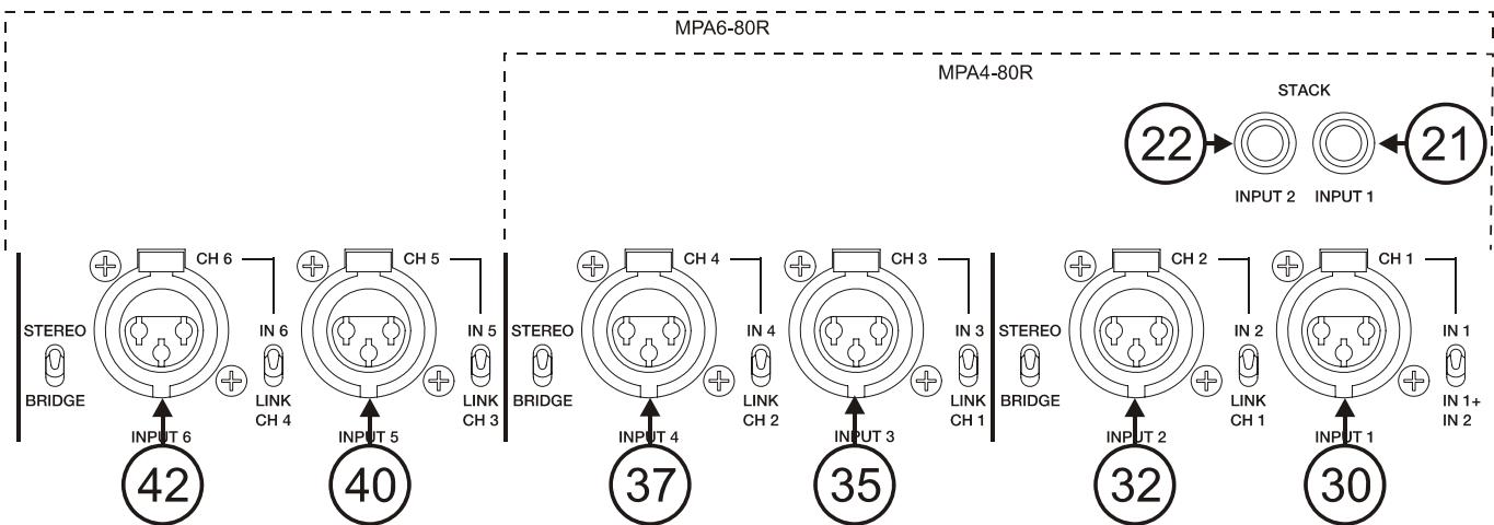
Die Eingangsbuchsen des MPA R (30, 32, 35, 37, 40, 42) sind elektronisch symmetrierte XLR-Buchsen mit einer Eingangsimpedanz von  $>20\text{k}\Omega$  und einer Nennempfindlichkeit von 0dBV(1V). Die Pinbesetzung ist:
