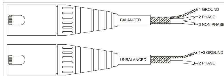
Die "STACK" Anschlüsse (21, 22) sind mit den Eingängen "INPUT 1 INPUT 2" parallel geschaltet und werden verwendet, um das gleiche Eingangssignal zu anderen Verstärkern oder Geräten zu senden. Diese Signalausgänge sind mit  $\frac{1}{4}$ " Klinkenbuchsen ausgestattet. Die Pinbelegung der Anschlüsse ist wie folgt:
