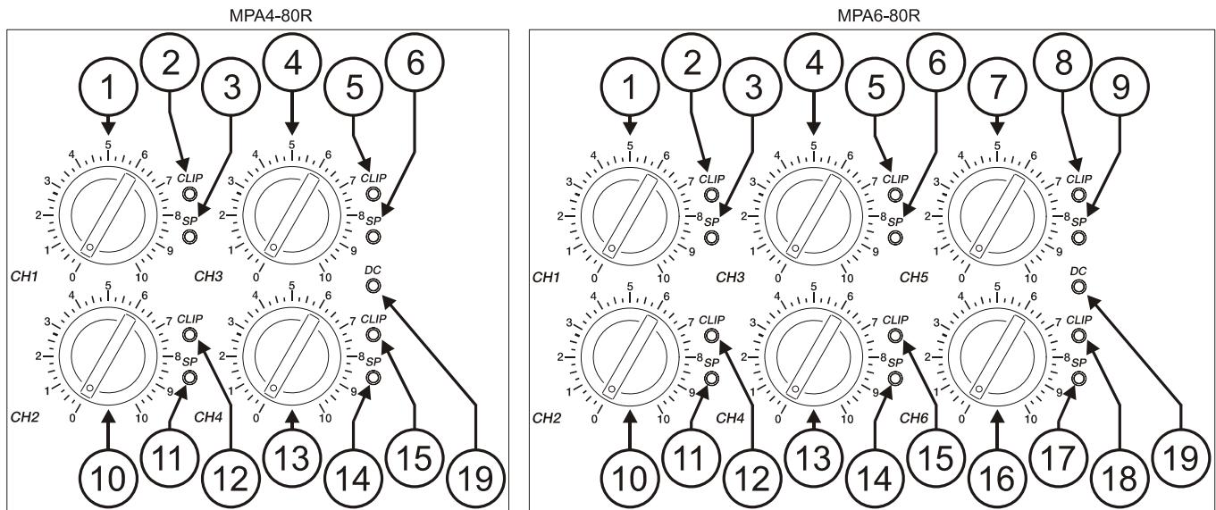
Ces atténuateurs permettent de connecter différentes consoles de mixage, de régler le volume de façon indépendante et de brancher des HP pouvant supporter une puissance inférieure à celle administrée par l'amplificateur à plein rendement, sans aucun danger de les endommager par une manipulation exagérée du volume de la console de mixage.
