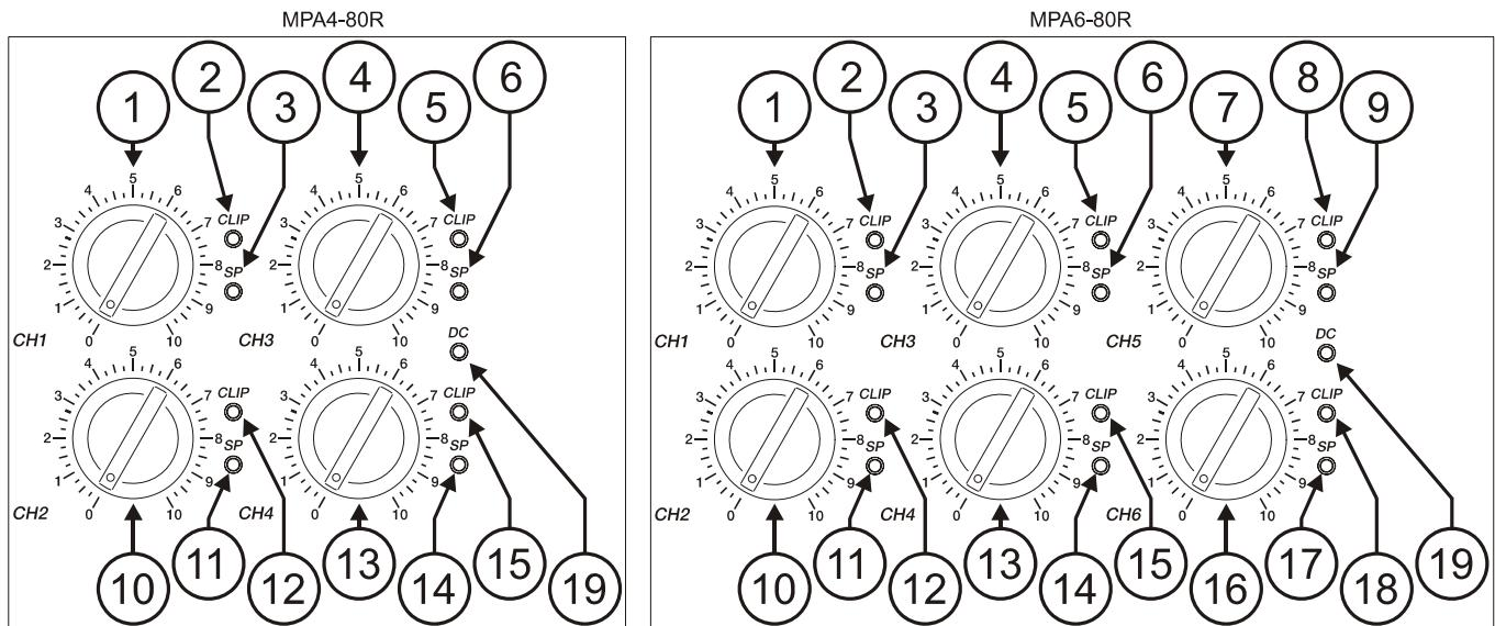
Diese Trimmer ermöglichen den Anschluss verschiedener Mischpulte oder Vorverstärker, unabhängige Volume-Regelung pro Kanal und den Anschluss von Lautsprechern, die die Höchstleistung des Verstärkers nicht bestehen würden. Damit wird die Gefahr, die Lautsprecher durch eine Fehlmanipulation am Mischpult oder Vorverstärker zu beschädigen beseitigt.
