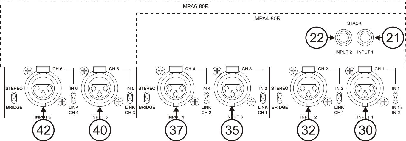
Las entradas de señal (30, 32, 35, 37, 40, 42) son del tipo XLR-3 balanceadas electrónicamente, con una impedancia de entrada superior a  $20\text{k}\Omega$  y una sensibilidad nominal de  $0\text{dBV}(1\text{V})$ . La asignación es la siguiente:
