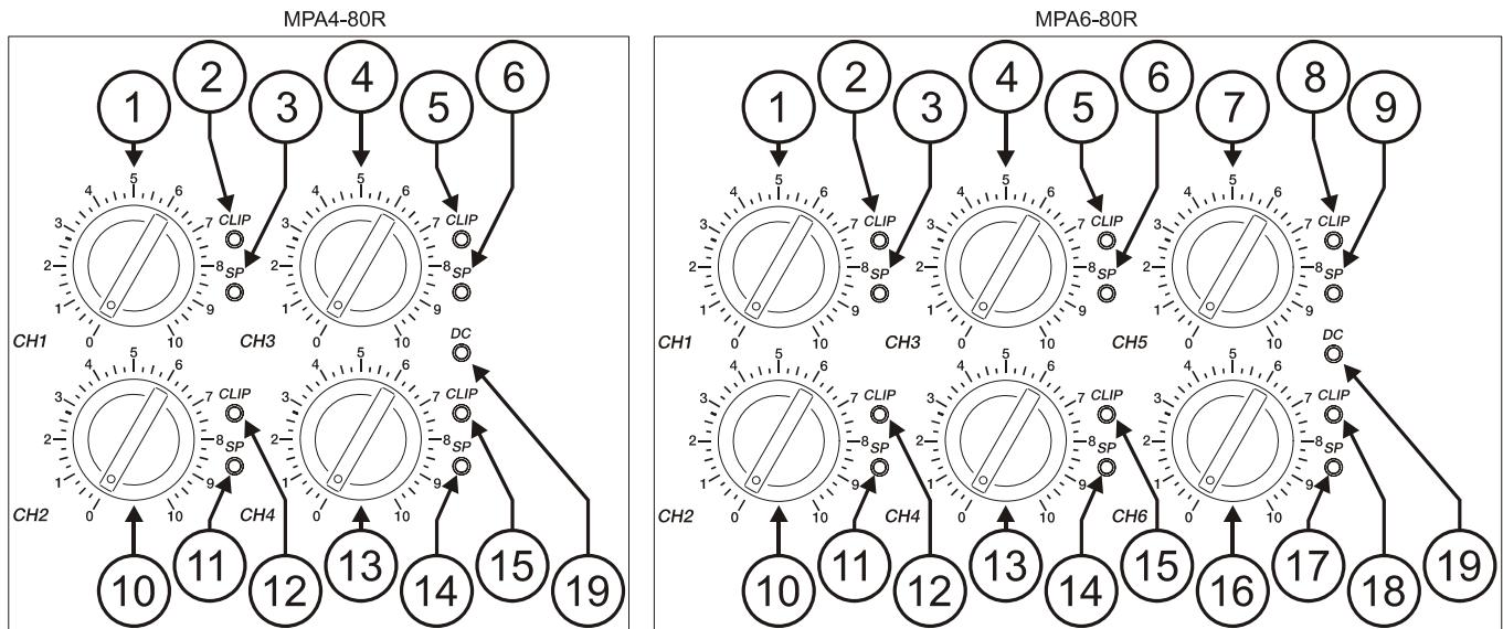
Estos atenuadores posibilitan la conexión a distintos tipos de mesas, regulación de nivel independiente y conexión de altavoces que soporten una potencia inferior a la suministrada por el amplificador a pleno rendimiento, sin peligro de dañarlos por un descuido al manejar el volumen del preamplificador-mezclador.
